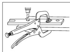
**Высокий, широкий зажимной рычаг с подвижными параллельными зажимными губками.**
