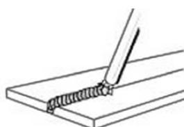
**Сварка в горизонтальном положении** выполняется во многом так же, как и сварка в нижнем положении, однако в данном случае используется другой угол, в результате чего электрод и, соответственно, давление дуги направлены больше в сторону металла над
