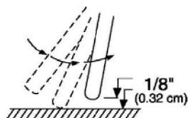
Важно поддерживать определенный зазор в ходе всего процесса сварки; при этом он не должен быть слишком широким или слишком узким. Если зазор слишком узкий, электрод «прилипает» к заготовке. Если зазор слишком широкий, дуга гаснет. Требуется много практики для выдерживания нужного зазора. У новичков обычно «прилипает» электрод
