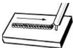
**Уширенный извилистый валик сварного шва**, который используется для наплавления металла по более широкой линии, чем это можно сделать при использовании узкого наплавленного валика (без переноса колебаний). Для наплавления валика данного типа, электрод перемещается поперечно из стороны в сторону с небольшой задержкой в конце каждого колебания в ходе продольного движения. Это оптимальный способ улучшения проплавления шва.
