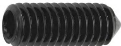
Класс твердости 45H соответствует твердости 450 HV. Стандартный наконечник расположен под углом 90°, более короткие — под углом 120°. Установочные винты из стали предназначены для использования только под давлением сжатия. Типичные сферы применения включают фиксацию в регулировочном кольце или подачу давления на контропору. Установочные винты из стали обладают необходимой прочностью и обеспечивают сопротивление скручиванию во внутреннем шестиграннике при затягивании/ослаблении.
