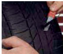
9. Установите шину на обод, накачайте воздухом до рекомендуемого давления и обрежьте выступающий хвост заплатки (без натяжения).
