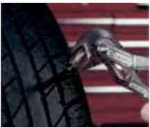
7. Протолкните хвостик через отверстие изнутри, до поверхности, обработанной цементом области, вытягивая его с внешней стороны шины.
