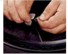
6. Снимите защитный слой заплатки не касаясь клейкой поверхности.
