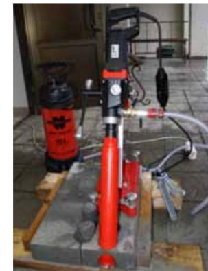
Как и «старшая сестра», установка DS 152 имеет три режима скорости (0–550, 0–1250, 0–2700 об./мин). Это опять же позволяет выбирать наиболее экономичный режим эксплуатации, повышает долговечность использования установки и коронок, обеспечивает совершен-
