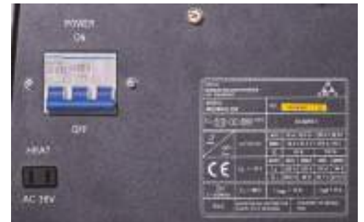
Трехфазный предохранитель на машине для дополнительной безопасности.
