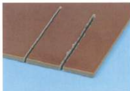
Сравнение резания алмазным кругом, толщиной 1,1 мм (слева) и стандартным кругом по бетону (справа)
