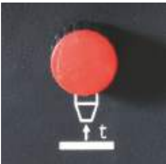
Функция «Сжигание» удаляет пятно на конце сварочной проволоки и обеспечивает легкий запуск сварки.
