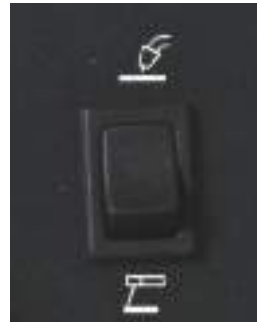
Два режима сварки - MIG / MAG и STICK (электрод)
